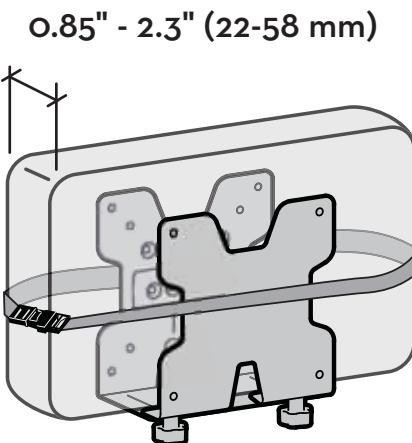
**BELANGRIJK!** Dit product voegt 2 extra 2 lbs. (1 kg) toe aan uw bevestigingssysteem. Als u dit bevestigt tussen een monitor en een VESA-plaat, dient de gewichtscapaciteit van de monitor van het bevestigingssysteem met 2 lbs. (1 kg) verminderd te worden als u standaard monitors en dunne bescherming gebruikt die samen minder dan of gelijk zijn aan 2,5" (64 mm). Indien de monitors en de dunne bescherming breder zijn dan 2,5" (64 mm) dik zijn zal een extra vermindering nodig zijn.
